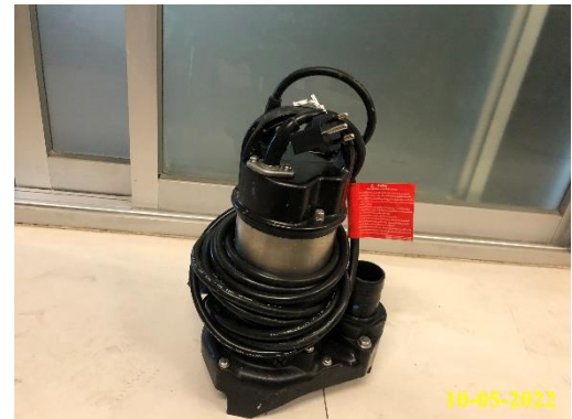
ภาพที่ 2.2-27 เครื่องสูบน้ำ
